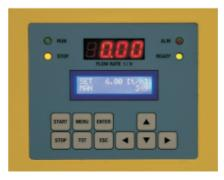
Le tableau de commande est simple d'emploie. Uniquement quelques touches et entrées de données sont nécessaires. L'affichage ACL facilite le réglage des paramètres par l'opérateur. Le débit de passage est directement affiché sur l'écran ACL rouge.
