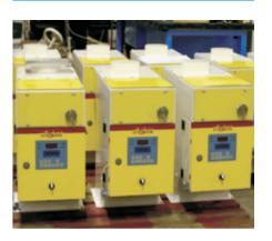
Trois systèmes de communication sont disponibles: Profibus DP / Modbus / TTY (current loop). Les doseurs DPM sont parfaitement intégrés dans les nouveaux systèmes d'automation, et d'autres systèmes déjà existants peuvent être remplacés sans autres.
