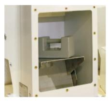
Le doseur est calibré sur place à l'aide d'un poids standard. Ce poids est posé sur le capteur qui mesure le débit de passage. Le système est déjà précalibré à l'usine. Pour le calibrage définitif sur place, il faut uniquement de simples opérations d'ajustage. A l'aide d'un vis d'ajustage extérieur il est possible de modifier l'inclinaison de la plaque afin d'obtenir la valeur du poids ultérieurement calibré.
