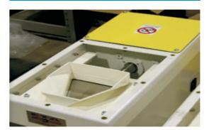
La commande pneumatique offre une haute sécurité, aussi pour l'opérateur. En cas d'une rupture de courant, la machine se met automatiquement à la position de fermeture, et le débit de passage est interrompu. Le câblage, le tableau de commande et tous les composants électroniques correspondent aux actuelles normes en vigueur. Les doseurs peuvent être livrés en option avec ATEX-standard utilisé en zone 22, approuvé par le TÜV.
